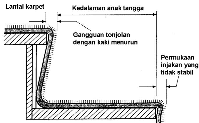
Gambar 5.2.3.5.(d) : Pengukuran anak tangga dengan permukaan injakan yang tidak stabil.
