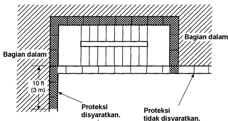
Gambar 5.2.5.2 ( c ) : Jalur tangga dengan dinding luar tidak diproteksi berhadapan dengan dinding luar yang bersebelahan dari bangunan.
