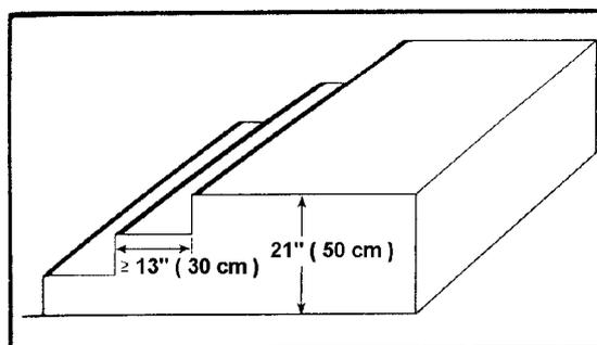
Gambar 4.1.6.2. : Perubahan ketinggian pada sarana jalan ke luar.
